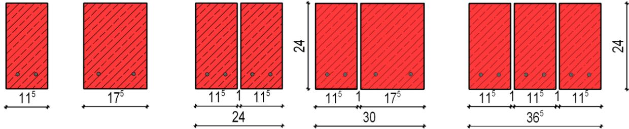
Mögliche Sturzkombinationen mit Wärmedämmung für Außenwände
